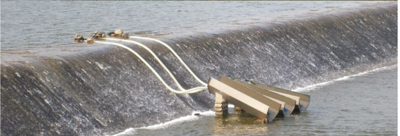
事例:現地でのサイホン取水での魚道実験例
