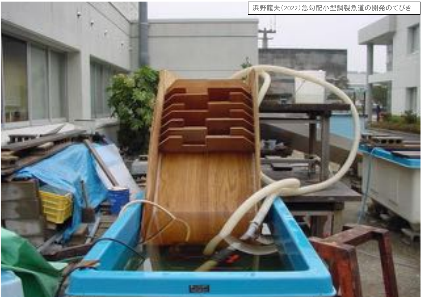
事例：陸上での魚道実験例
