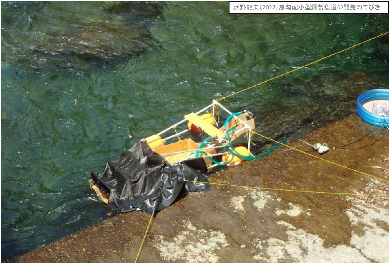
応用事例: プールに浮かして実験できるようにした魚道の実験風景。ポンプ電源は陸上から。魚が入りやすいように入口を遮光。 → 場所選定を失敗。そもそもアユがいなかった(・_・)
