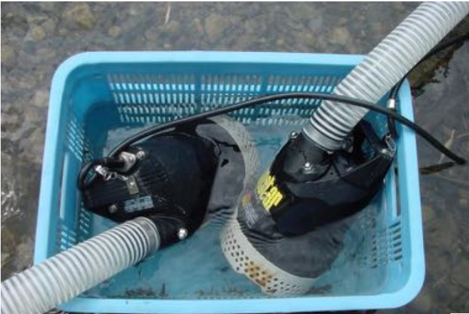
投げ込み式ポンプからの取水例
