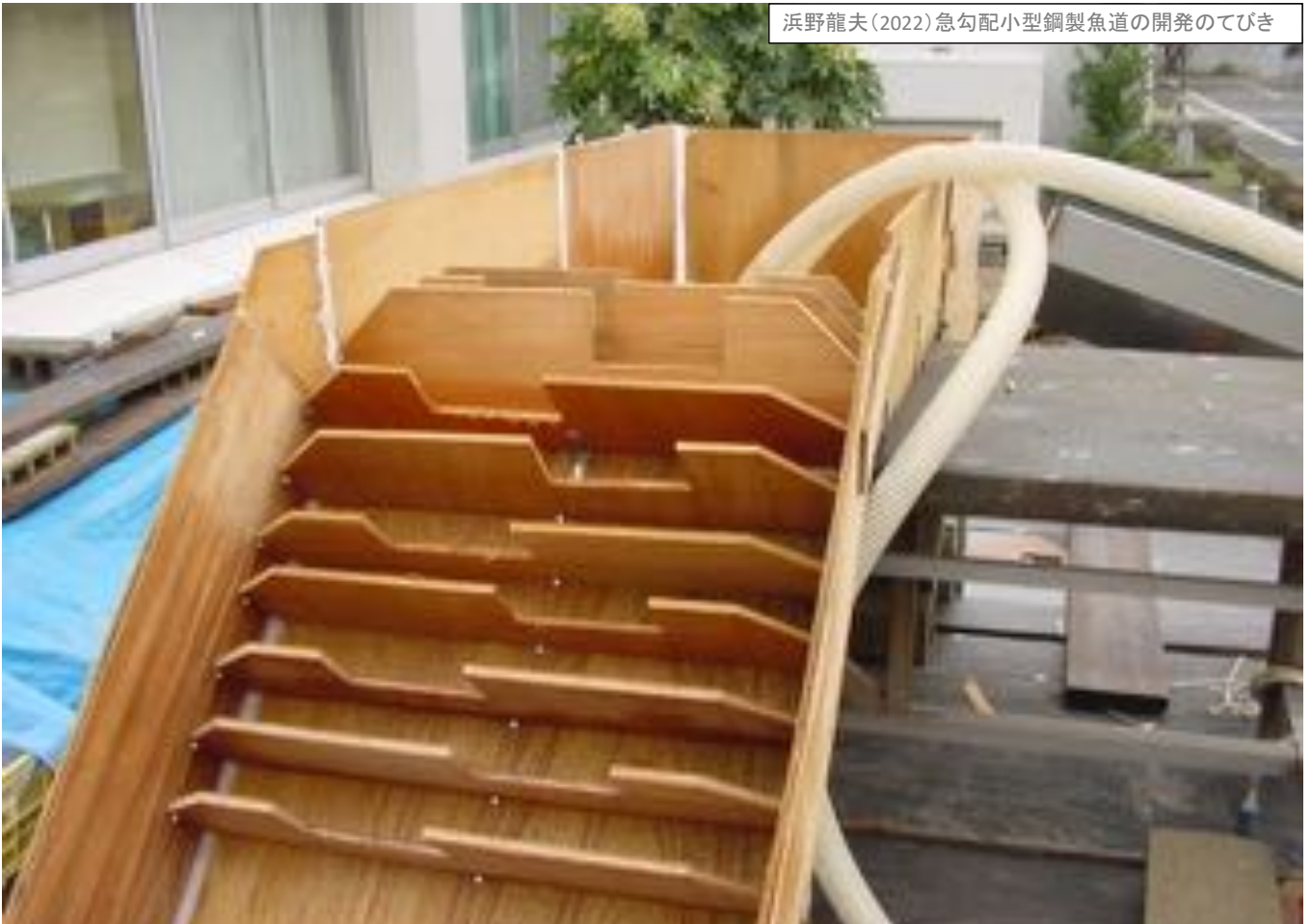
事例：陸上での魚道実験例
