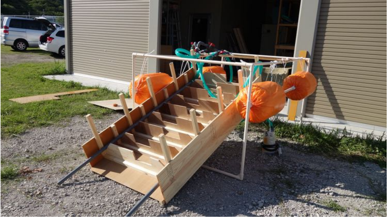
応用事例: プールに浮かして実験できるようにした魚道
